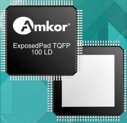
Amkor 的 ExposedPad LQFP/TQFP 电源 IC 封装系列能够显著提升功率限制标准的 LQFP 和 TQFP 的热效率。相对于标准 LQFP/TQFP 封装，此类封装能够将散热效率提升至 110%，对运行参数进行了扩展。除此以外，ExposedPad 也能连接至接地面，从而减低线弧电感，适用于高频率应用。ExposedPad 应该直接焊连到 PCB，以创造热性能和电气性能优势。针对 MCP 解决方案，Amkor 还提供晶片堆叠制程的 3D 封装。
